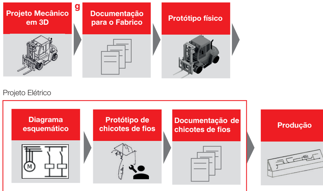
Figura 5: O desenvolvimento de cabos 3D com um pro-tótipo digital reduz o processo de desenvolvi-mento, aumenta a qualidade e garante uma produção eficiente a longo prazo.
